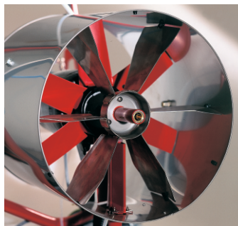
System dysz i twornika dmuchawy do kierowania strumieniem powietrza.
